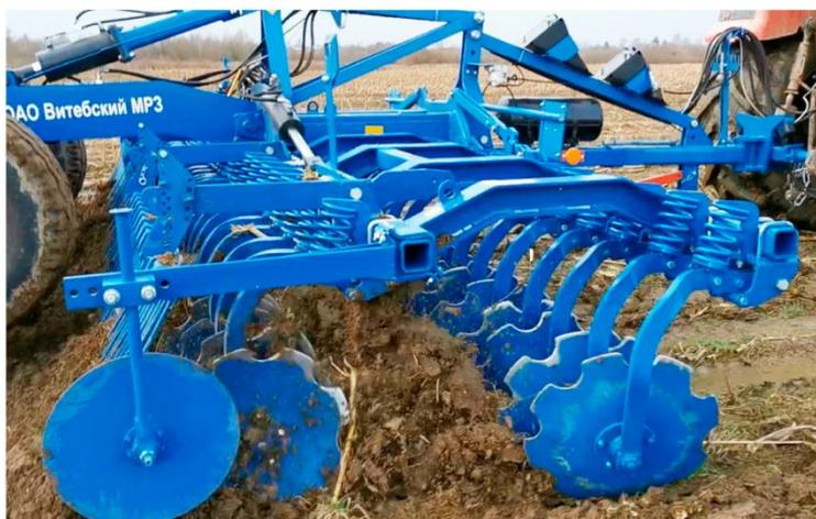
Открытая конструкция рамы с большим свободным пространством обеспечивает бесперебойную работу агрегата даже при большом количестве растительных остатков.
