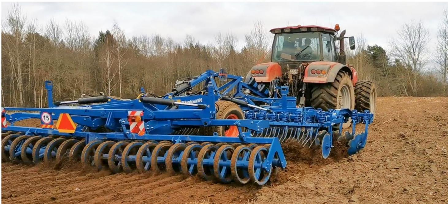
Агрегат дисковый почвообрабатывающий АД-600М «Рубин» обеспечивает в тяжелых почвенных условиях интенсивное и равномерное перемешивание органической массы и почвы, при этом значительно снижая потерю влаги от испарения. Таким образом, борона отлично подходит для поверхностной, а так же равномерной стерневой обработки почвы при высокой рабочей скорости. Агрегат предназначен для эксплуатации на легких, средних и тяжелых почвах.
