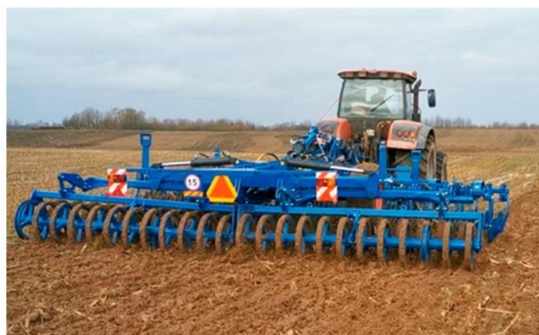
Агрегат дисковый почвообрабатывающий АД-600М «Рубин»
